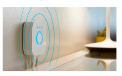
Die Hue Bridge ist ein essentieller Bestandteil jedes intelligenten Philips Hue-Beleuchtungssystems. Sie ist das "Gehirn" der Bedienung und kommuniziert mit den intelligenten Leuchten und der Hue-App, um sicherzustellen, dass alles gut zusammenwirkt. Dazu ermöglich sie intelligente
