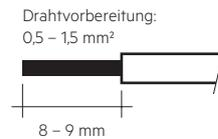
**3.3 Lösen der Klemmverdrahtung**
